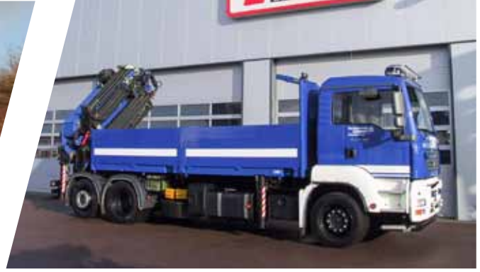
Transportpritsche mit Heckkran für 20' Container Platform Body with Rear Crane for 20' Container
