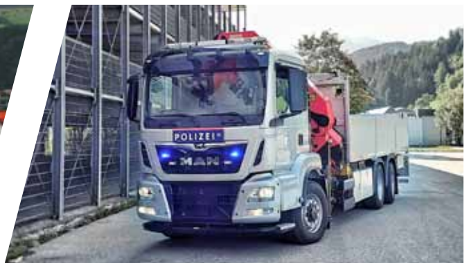
Pritsche mit Kran und Ladebordwand Plank-Bed Vehicle with Crane and Tail Lift
