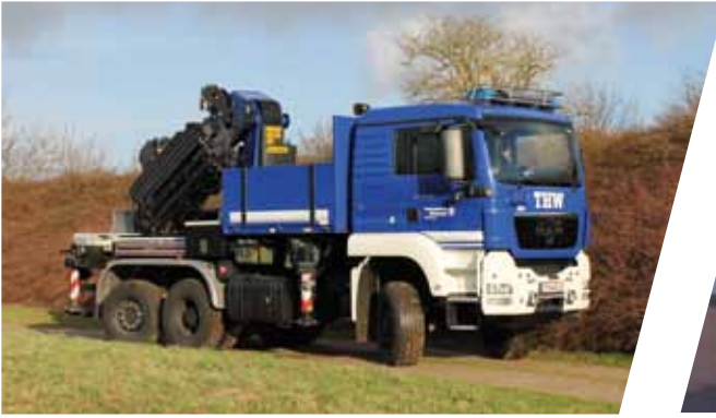
Brückenlegekranfahrzeug Bridge-Laying Vehicle
