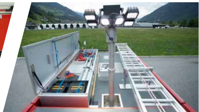
Begehbare Aufbau- und Kabinendach Walk-on body and compartment roof
