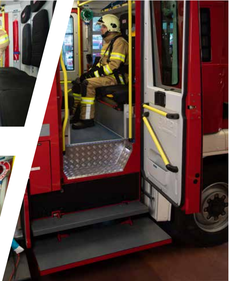
pneumatisch abklappbare Auftritte pneumatically folding access step
