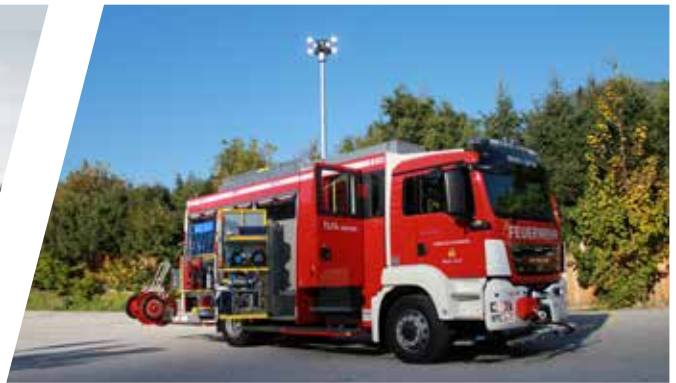
Tanklöschfahrzeug, TLF-A 4000/200 Pumper, TLF-A 4000/200
