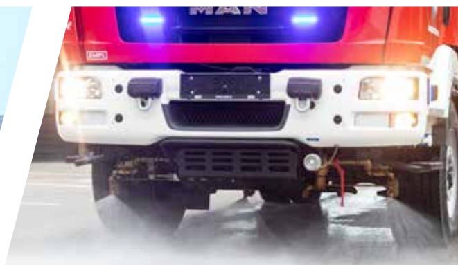
Straßenwasch- und / oder Selbstschutzanlage Street washing nozzles
