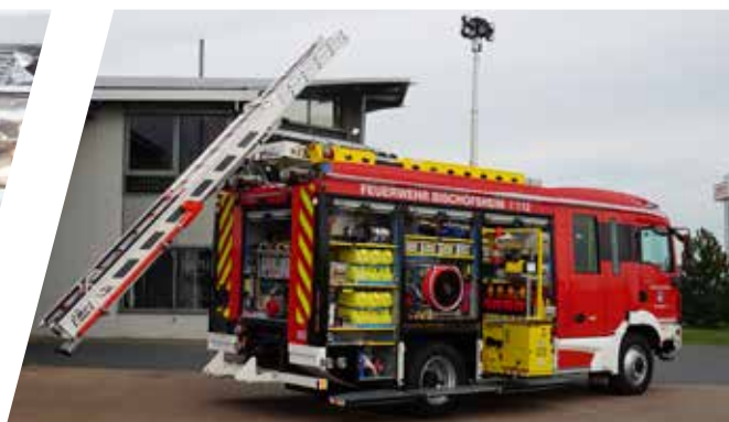
Mechanisch oder elektrische Leiterabsenkung Ladder lowering device, mechanical or electrical
