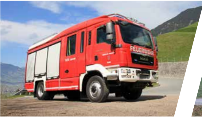
Tanklöschfahrzeug, TLF-A 1500/200 Pumper, TLF-A 1500/200
