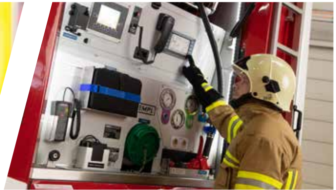
Ergonomisch bedienbare Pumpensteuerung nach Kundenwunsch Pump control / ergonomic operation
