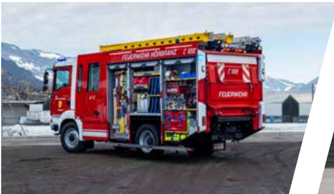
Löschfahrzeug mit Roll-Container, LF-C Pumper with roll-on container
