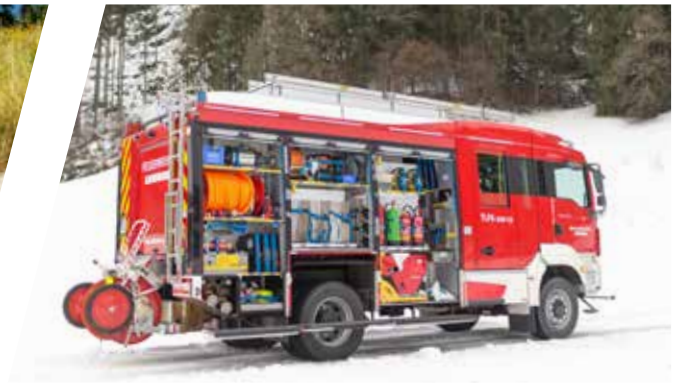
Tanklöschfahrzeug, TLF-A 3000/120 Pumper, TLF-A 3000/120
