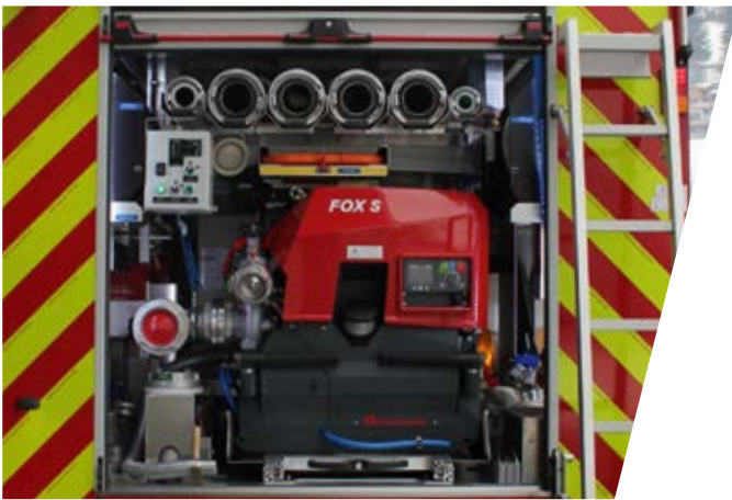
TS-Einbau im Fahrzeug-Heck Portable Pump at the tail end of the vehicle
