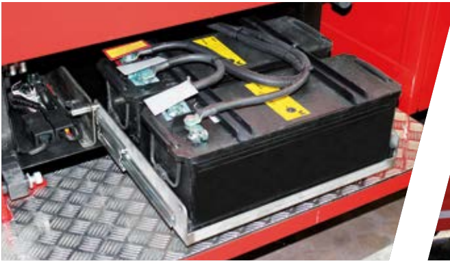
Batterien auf Edelstahlauszug hinter Trittstufen Batteries behind the fold-out step on a stainless steel extension
