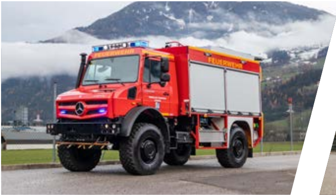
Tanklöschfahrzeug, TLF 3000 Pumper, TLF 3000
