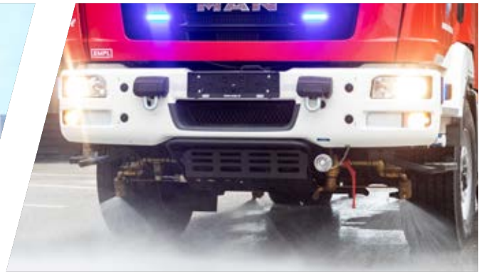
Straßenwasch- und / oder Selbstschutzanlage Street washing nozzles
