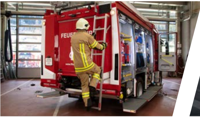
Selbstarretierende Heckaufstiegsleiter mit Schrägstellung Self-locking rear ladder held in a slant position
