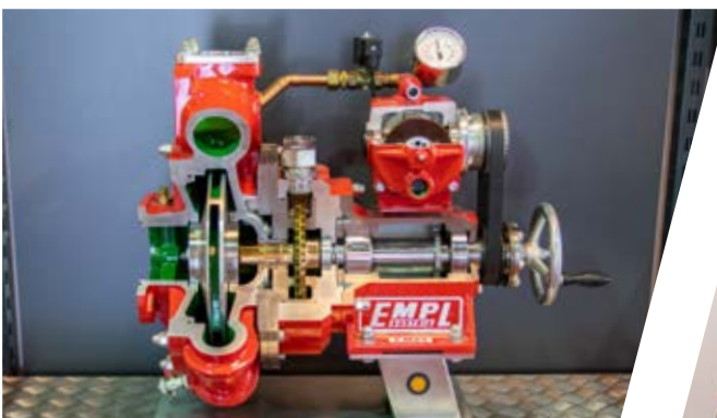
Pumpenschnitt mit Niederdruck und Hochdruck Pump section
