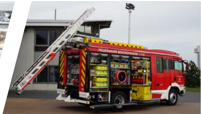
Mechanische oder elektrische Leiterabsenkung Ladder lowering device, mechanical or electrical
