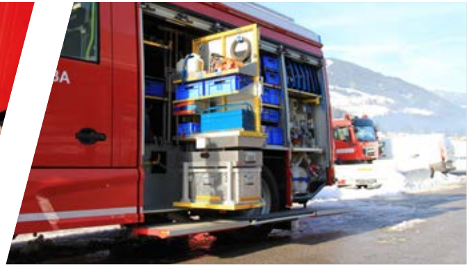
Drehwände variabel, getrennt oder durchgehend Rotating shelves
