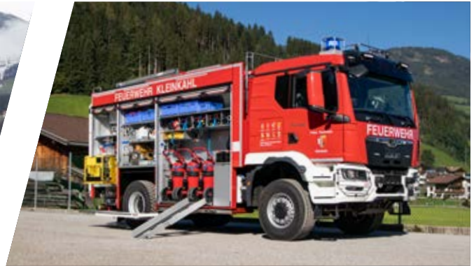
Tanklöschfahrzeug, TLF 4000 Pumper, TLF 4000
