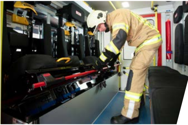
variabel einteilbarer Stauraum in Sitzkästen flexible partitioning of storage space in seat boxes
