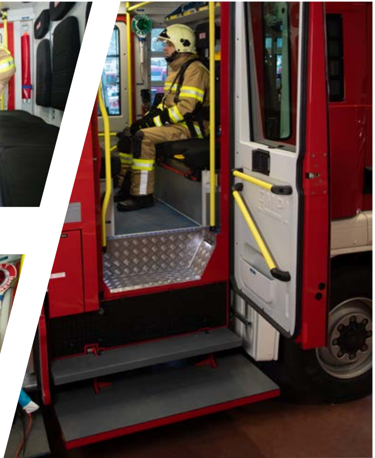
pneumatisch abklappbare Auftritte pneumatically folding access step
