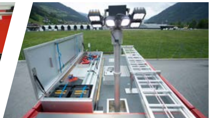
Begehbare Aufbau- und Mannschaftskabinendach Walk-on body and crew compartment roof
