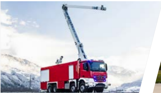
Industrielöschfahrzeug mit Scorpio Löscharm, ILF Industrial Fire Fighting Vehicle with extinguishing boom „Scorpio“
