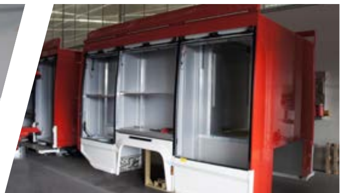
Aufbau aus kunststoffbeschichteten Aluminium Sandwich-Paneele Body made of aluminium sandwich panels
