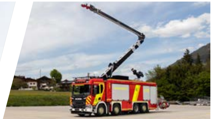
Universallöschfahrzeug mit Scorpio Löscharm, ULF Industrial Fire Fighting Vehicle with extinguishing boom „Scorpio“
