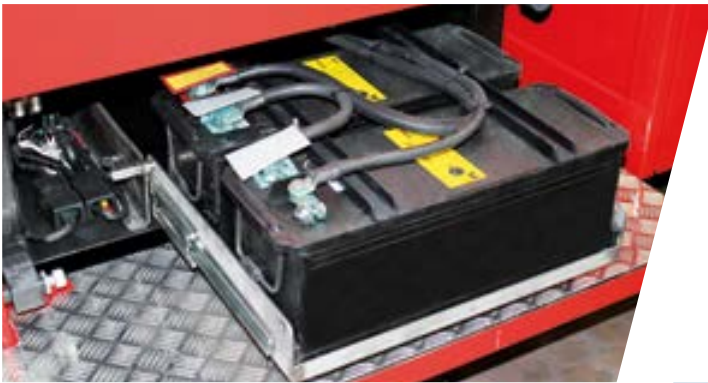
Fahrgestell-Batterien auf Edelstahl auszug hinter Trittstufen
