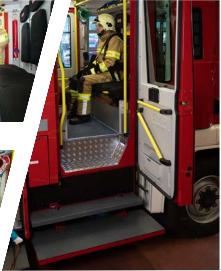
pneumatisch abklappbare Auftritte pneumatically folding access step
