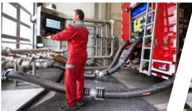
Pumpenprüfstand Pump test stand
