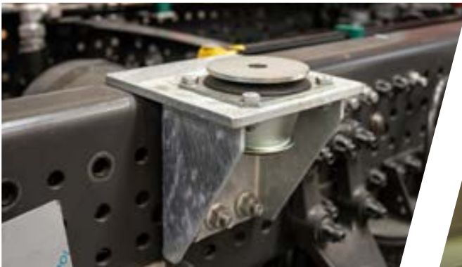
Lagerungskonsole Aufbau Supporting point for the body
