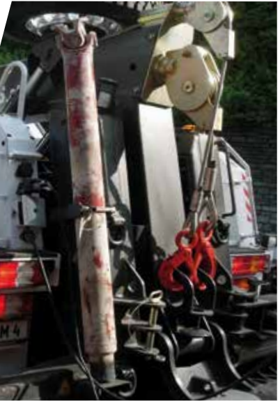
Halterung für Kardanwelle am Stützfuß
