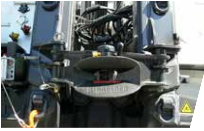
schwenk- und abnehmbare Anhängerkupplung
