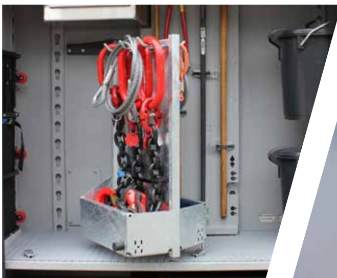
Schwenkwand mit beidseitiger Halterung für Ausrüstung
