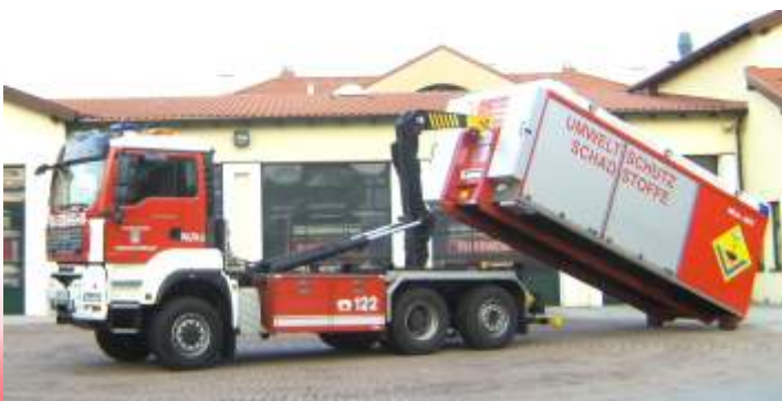
Wechseladefahrzeug mit Dekontaminationscontainer (WLF)
