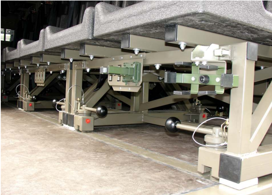
Abb. 4: Verankerung des EMPL Sicherheits-Sitzmoduls im Pritschenboden
