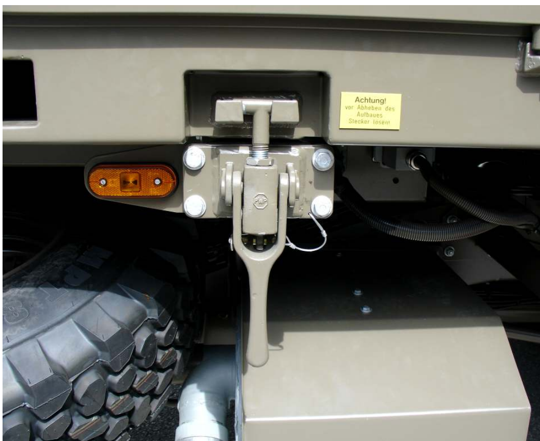
Abb. 3: Verriegelung des Wechselaufbaus
