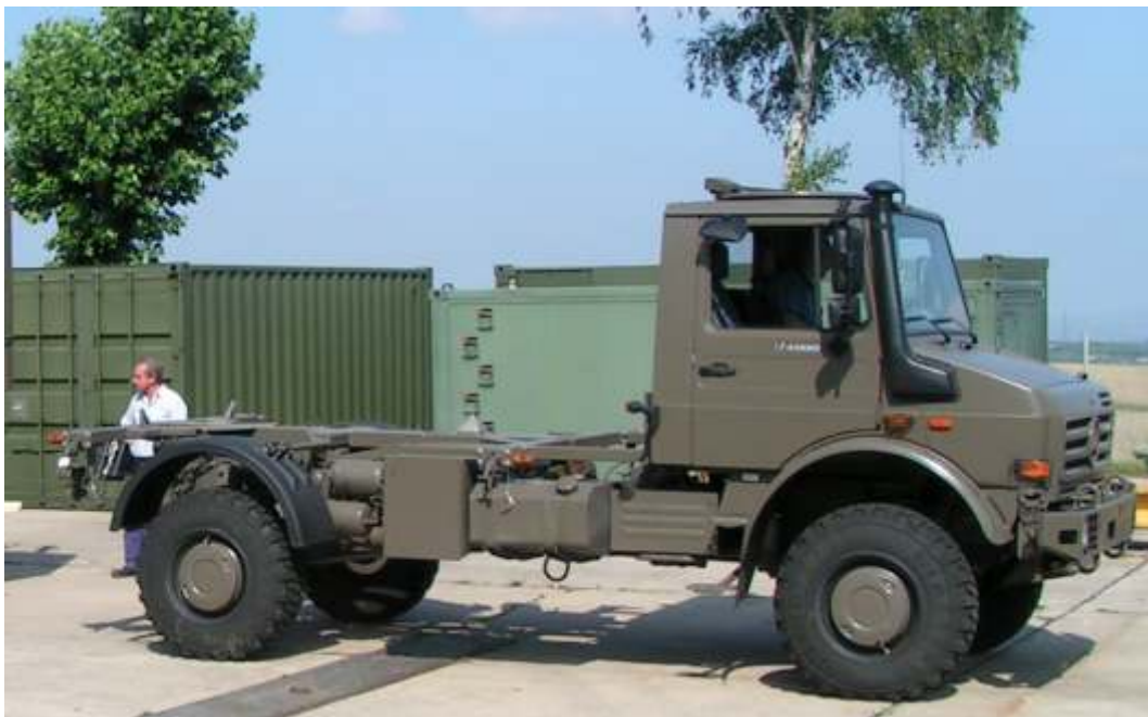
Abb. 2: Fahrzeug mit verwindungsfreiem Zwischenrahmen
