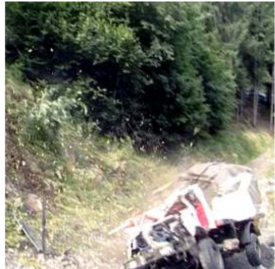
Abb. 29+30: Fahrzeug nach dem Aufprall im freien Fall (Phase 2)
