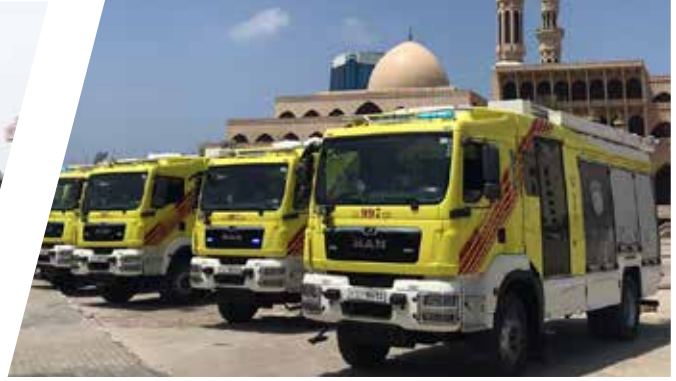
Tanklöschfahrzeug PRIMUS, TLF 3000/400 Pumper PRIMUS 3000/400
