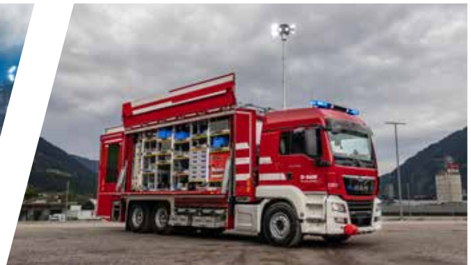
Rüstwagen mit Seiten- und Hecklift, RW Rescue Vehicle with side and rear lift
