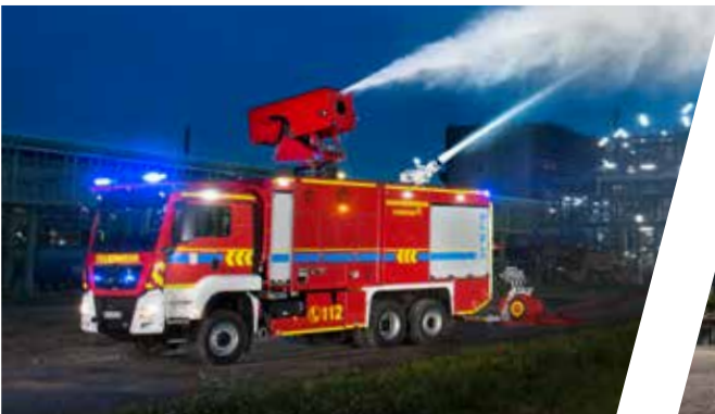
Turbinenuniversallöschfahrzeug, TULF Hydro Jet Fire Fighting Vehicle
