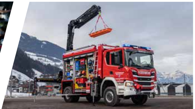
Schweres Rüstfahrzeug mit Kran, SRF-A Heavy Duty Rescue Vehicle with crane
