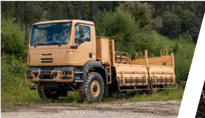
Transport de troupes avec banquettes latérales rabattables Vehículo de transporte de tropas con bancos de asientos laterales plegables
