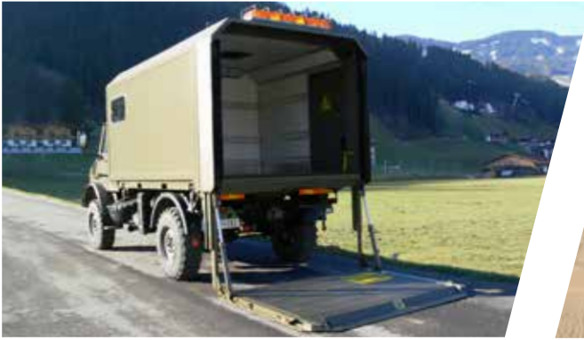
Wechselaufbau Koffer mit Hecklift Interchangeable Van Type Body with Hydraulic Tailgate
