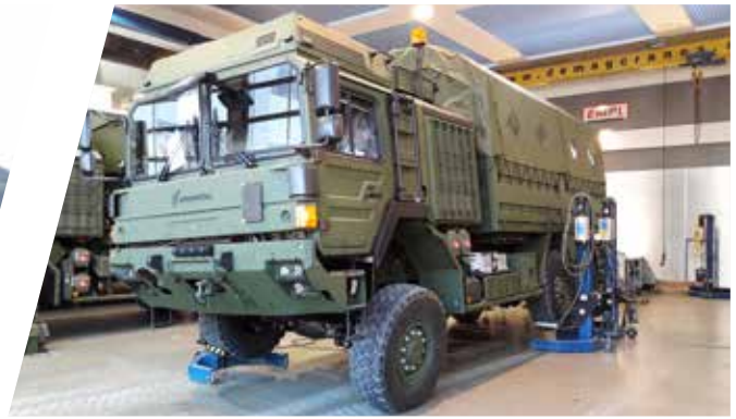
Statische Diagonalverwindung Static Torsion Test
