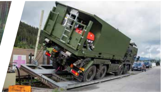
Statischer Kipptest Static Tilting Test
