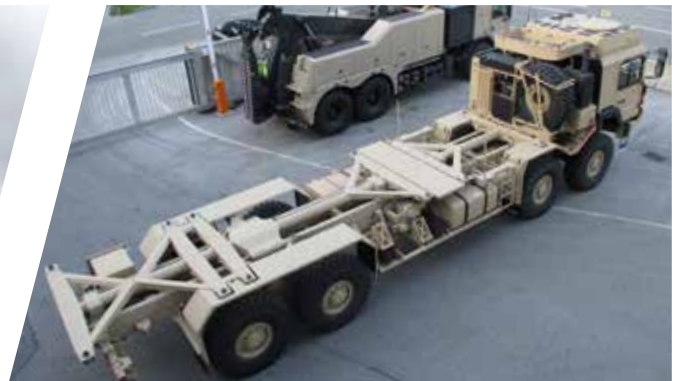
Doppelter verwindungsfreier Sheltertragrahmen Twin torsion free shelter carrier
