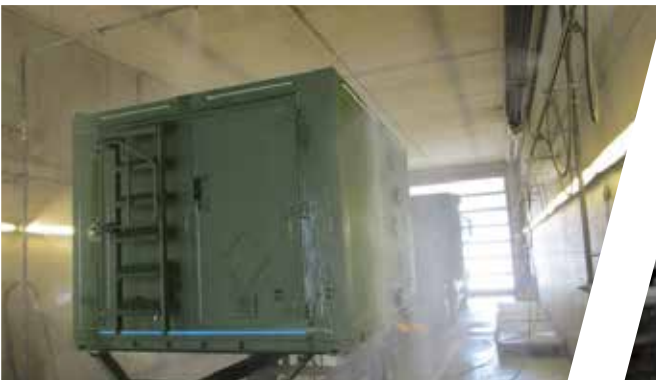
Dichtheitsprüfung / Regentest Leak Detection / Rain Test
