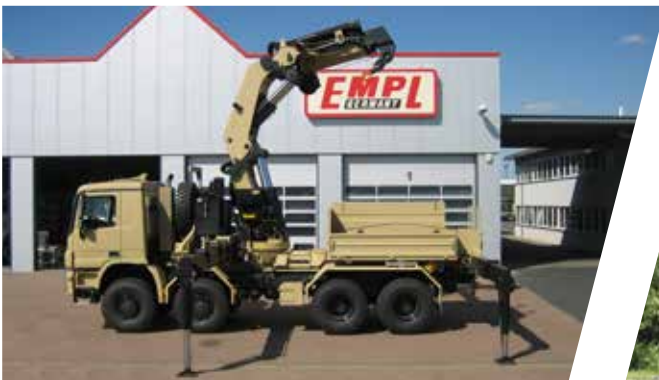
150 mto Kran mit Ballastpritsche 150 mto Crane with Ballast Cargo Body
