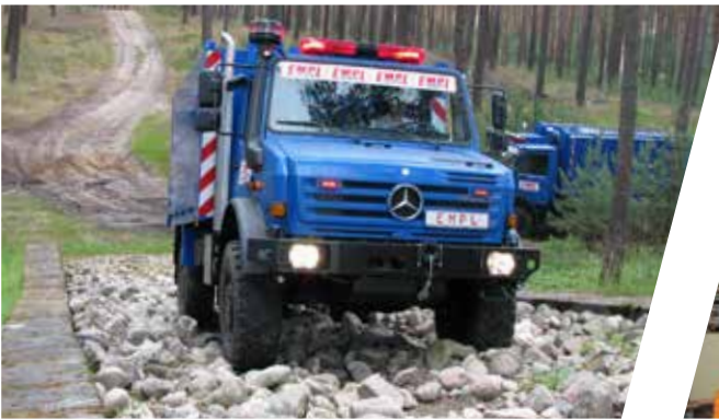
Fahrzeugüberprüfung am losen Geröllhang Verification of vehicle on loose gravel slope
