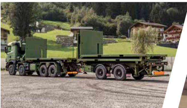
HLS mit Zentralachsanhänger und Flat Racks HLS with Tandem Trailer and Flat Racks
