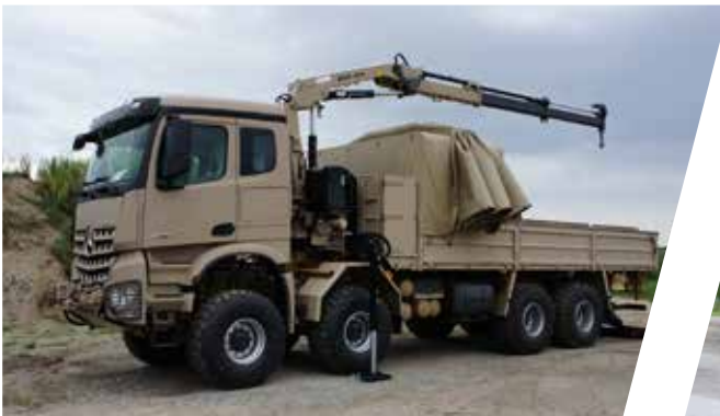
Pritsche mit Schieberverdeck und Kran Cargo Body with Sliding Tarpaulin and Crane
