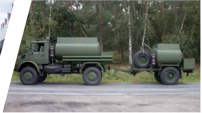
Treibstofftank mit Anhänger Fuel Tank Body with Trailer
