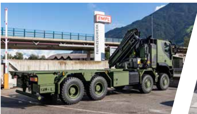
Containerrahmen mit Kran und Winde Shelter Frame with Crane and Winch
