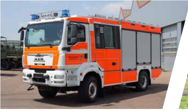
مركبة مجموعة مكافحة الحرائق للحماية من الكوارث، LF 20 KatS Pumper for civil protection
