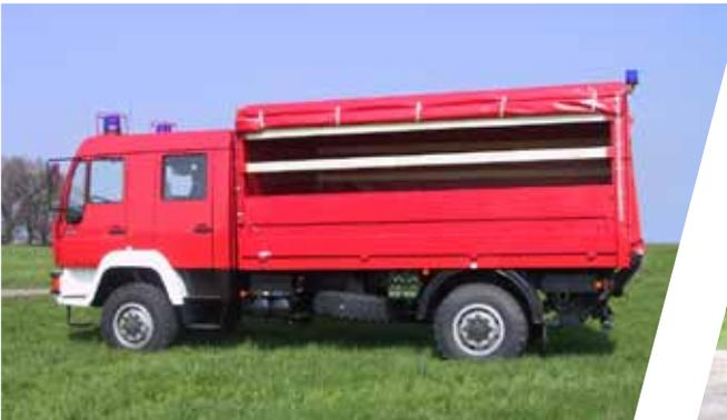
**Dekontaminationslastkraftwagen Personen, Dekon-LKW P**
