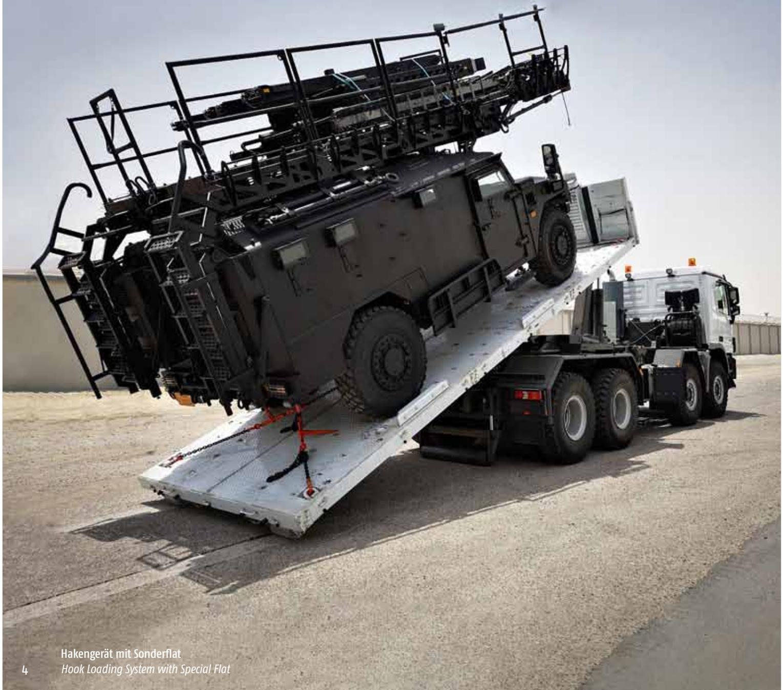
Hakengerät mit Sonderflat
