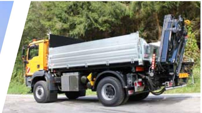
**Kipper mit abnehmbarem Heckkran**
