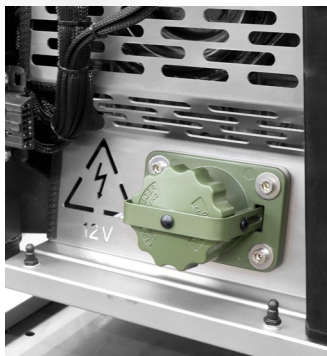
NATO-Fremdstartsteckdose 12 V DC und OBD II Diagnosestecker
