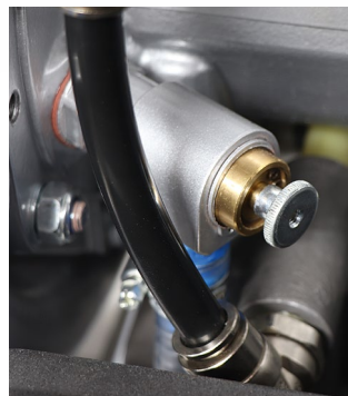
Mechanisches Thermostatventil mit Spülfunktion serienmäßig
