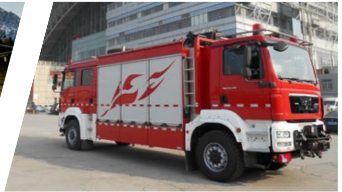
مركبة إطفاء بخزان مياه مزدوجة الكابينة Pumper Double Head (Tunnel Extinguishing Vehicle)
