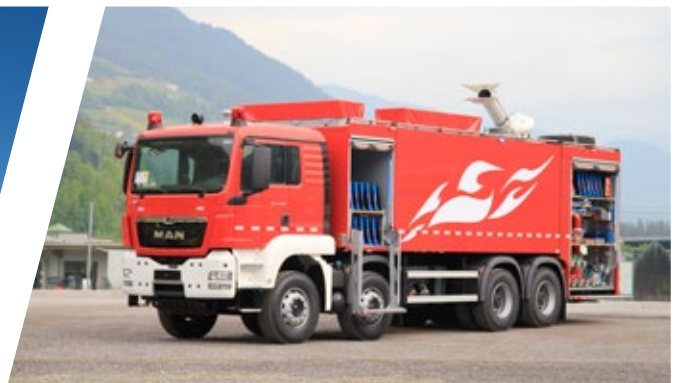
مركبة إطفاء بصهرج، TLF 20000 Pumper 20000
