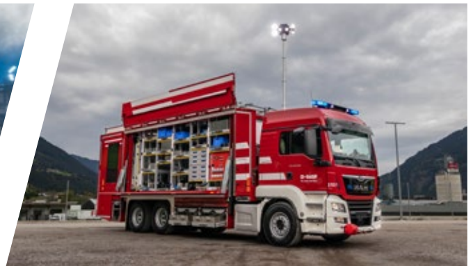
مركبة إنقاذ ذات رافعة جانبية وخلفية، RW Rescue Vehicle with side and rear lift
