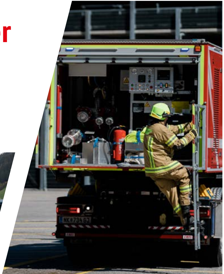
Abrollbehälter mit Wasser / Schaum Tank Roll-off Container with water / foam tank
