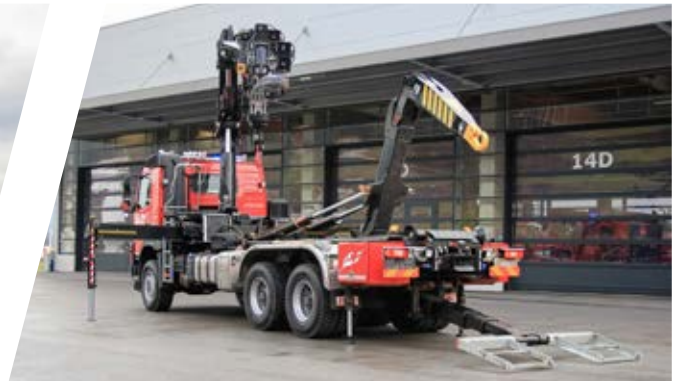
Wechseladefahrzeug mit Kran und Abschleppbrille, WLF Hook Loading System with crane and wheel lift
