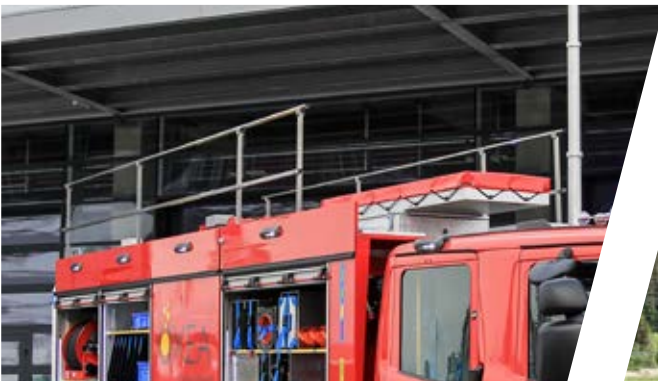
Dachgeländer Roof railing
