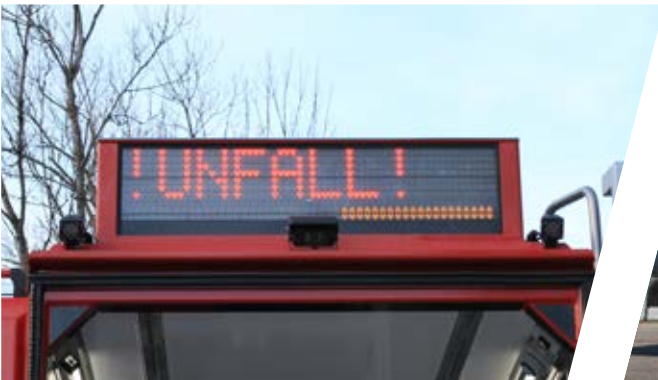
Verkehrsleiteinrichtung Rear warning system
