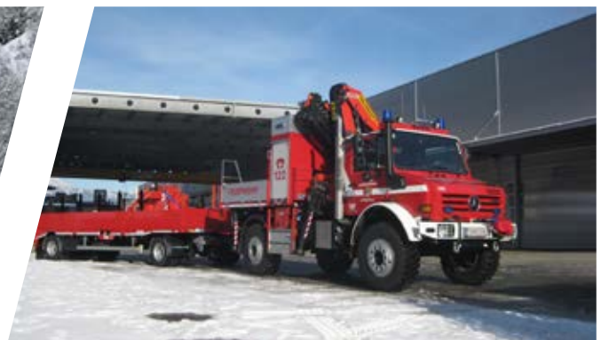
Versorgungsfahrzeug mit Kran, VF Supply Vehicle with crane
