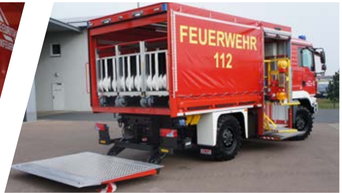
Ladungssicherung ohne Spanngurte möglich Load securing without tensioning belts
