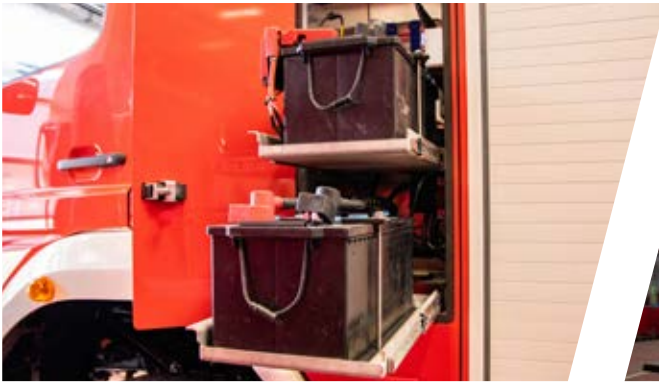
Batterien seitlich hinter dem Fahrerhaus eingebaut Batteries behind the drivers cab
