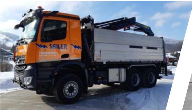
**Kipper mit Stahlbordwänden und Heckkran**
