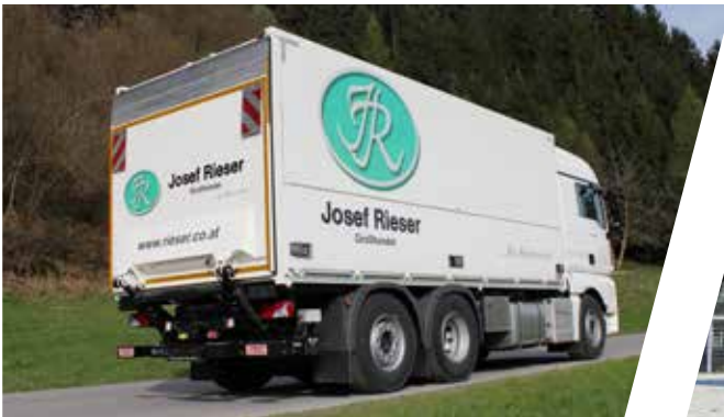
Superstructure à parois pivotantes avec hayon élévateur Caja con cartolas abatibles y plataforma elevadora
