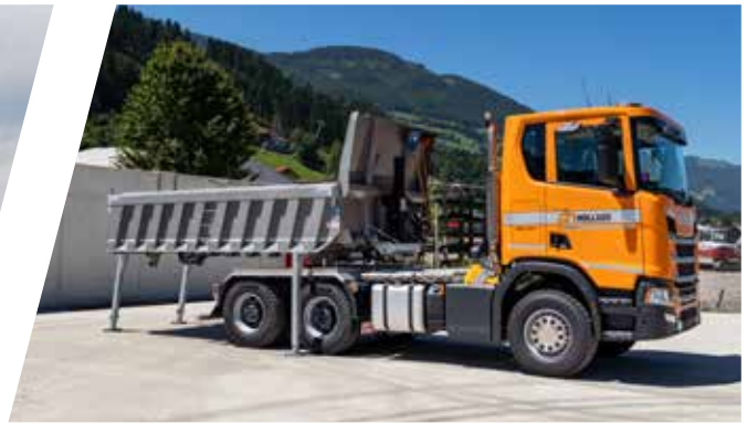
Benne à enrochement avec système interchangeable intégré Caja reforzada con sistema de cambio integrado
