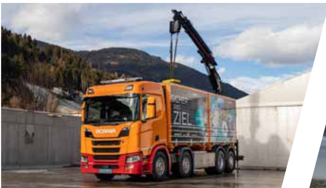
Camion-benne spécial avec grue pour le transport du verre usagé Volquete especial para residuos de vidrio, con grúa
