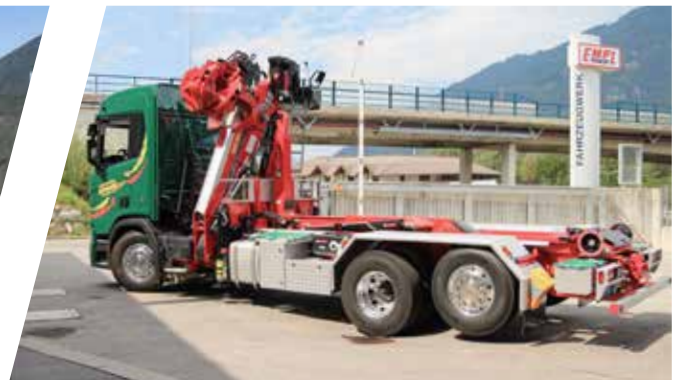
Bras de manutention à crochet avec grappin à ferraille Sistema de gancho con pinza para chatarra
