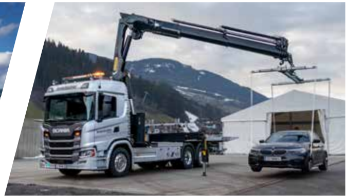
Plateau coulissant avec grue frontale Plataforma deslizando con grúa delantera
