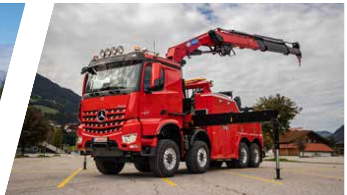
Dépanneuse EH/W 200 Bison avec grue frontale Vehículo de rescate EH/W 200 Bison con grúa delantera
