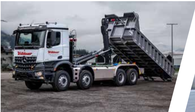
Système à crochets avec benne à enrochement Sistema de gancho con caja reforzada
