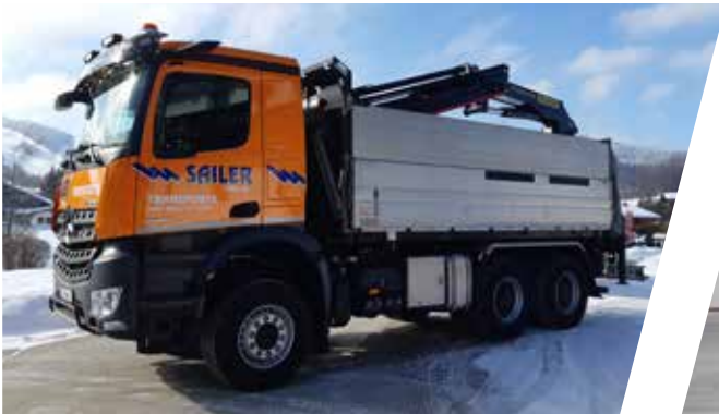
Camion-benne avec ridelles en acier et grue arrière Volquete con cartolas de acero y grúa trasera
