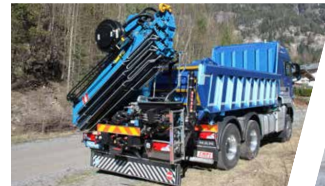
Gesteinsmulde mit integriertem Wechselsystem und Kran
