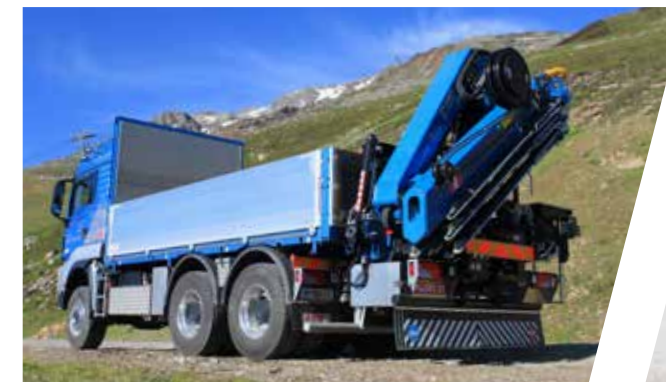
Pritsche mit integriertem Wechselsystem und Kran
