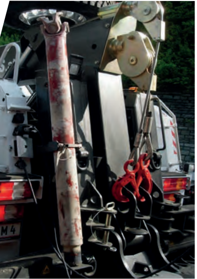
دعامة تثبيت لعمود الكردان مثبتة على الدعامة الأرضية
