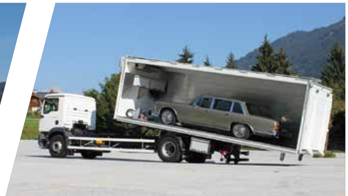
Schiebeplateau mit geschlossenem Aufbau & Klimaanlage für VIP Fahrzeuge Sliding Platform with box body and air conditioner for VIP vehicles
