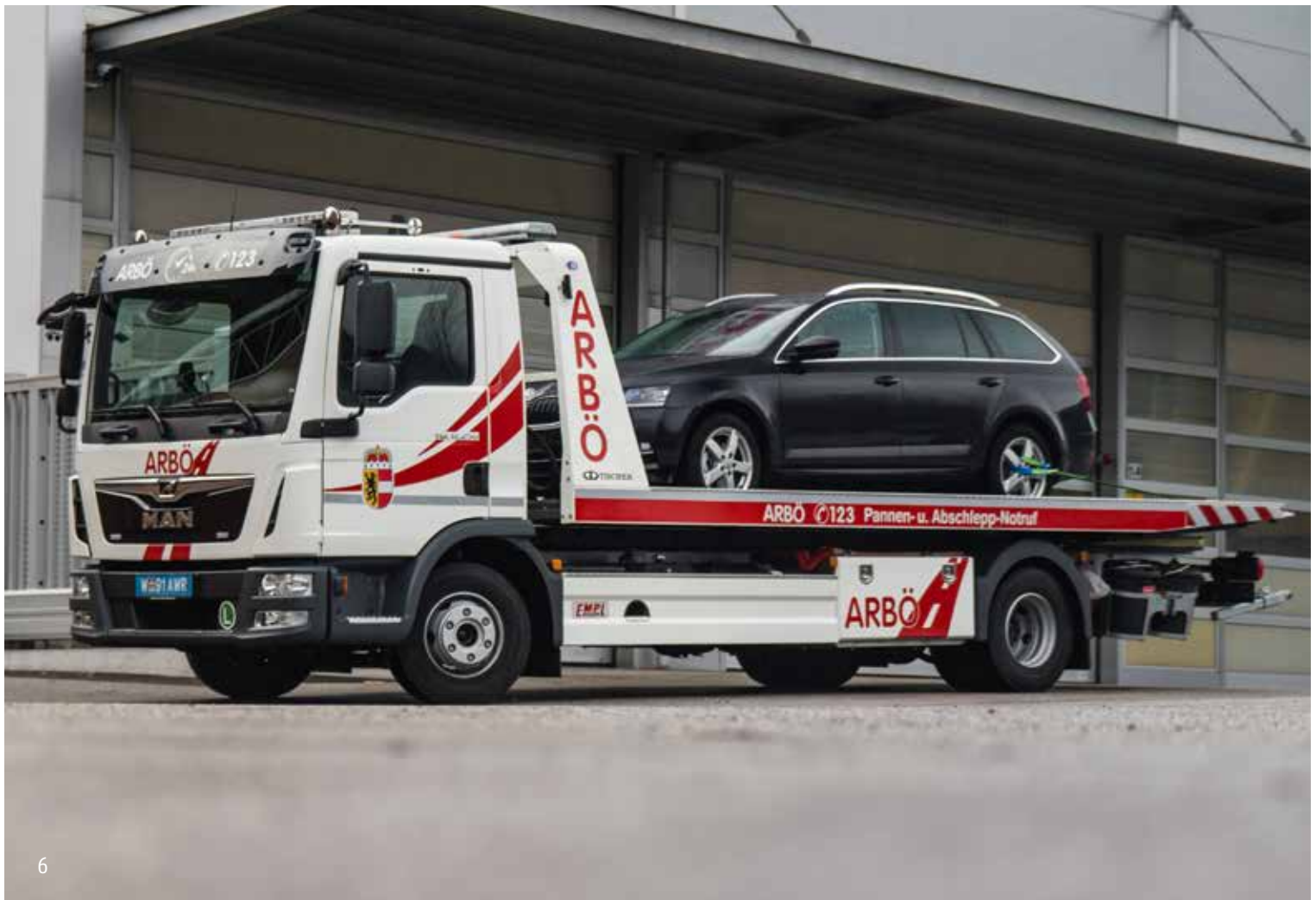
Hubbrillenfahrzeug leicht mit Winde und Staukästen Recovery Vehicle with underlift, winch and storage compartments
