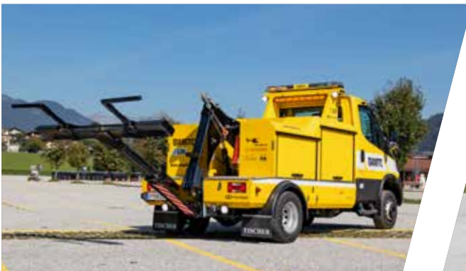
Hubbrillenfahrzeug leicht mit Winde und Staukästen Recovery Vehicle with underlift, winch and storage compartments
