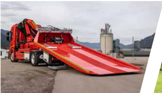
4t Schiebeplateau mit 5t Abschleppbrille und Kran Sliding Platform, 4to capacity with 5to lifting grid and crane
